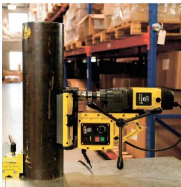
Возможность включения/отключения магнита
